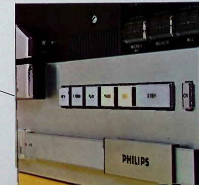
N 4418 Durch die neuartige Laufwerk-Konzeption können alle Bandlauffunktionen und die Aufnahme jetzt elektronisch gesteuert werden. Rückmeldung der eingegebenen Funktion erfolgt durch Aufleuchten der betreffenden Taste.
