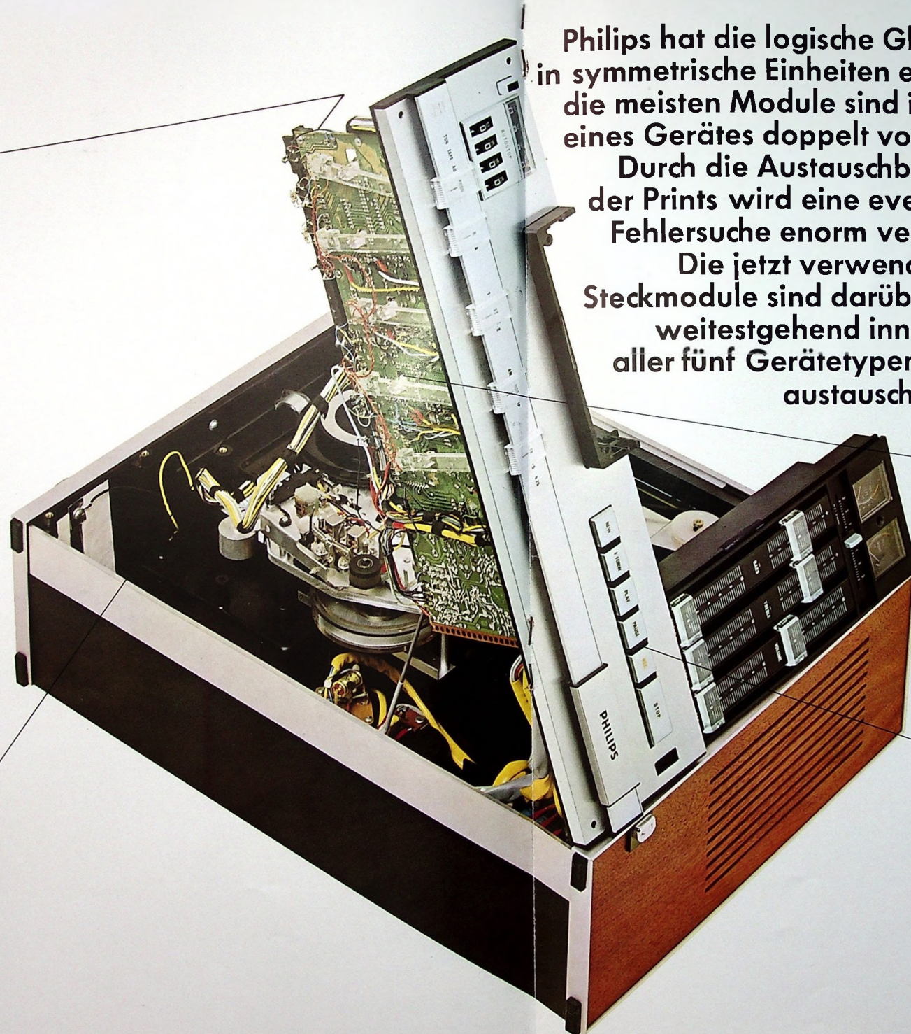
N 4418 Deutlich erkennbar die paarweise Anordnung gleicher Module.
